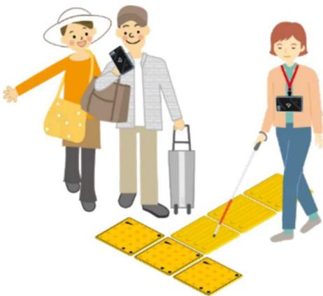
※「コード化点字ブロック」は、金沢工業大学情報工学科の松井くにお教授が中心となり開発されたもので、点字ブロックの突起の周りにつけられた丸と三角をスマートフォンアプリ「Walk & Mobile」で読み取ることで、視覚障害者に必要な周囲の情報を音声で伝えることができます。
